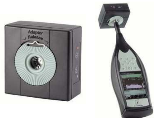
Obr.9: Kalibrátor značky B&K a jeho použití (nasazení na zvukoměr). Převzato z www.bksv.com .
