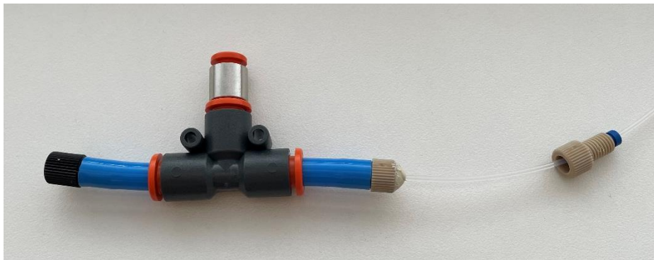
Obrázok 32 T-kus na pripojenie k mikrofluidnému systému
