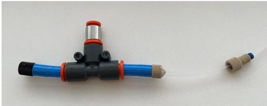
Obrázok 32 T-kus na pripojenie k mikrofluidnému systému
