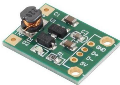
Obrázok 25 Menič step UP DC/DC 1-5 V to 5 V 500 mA [15]
