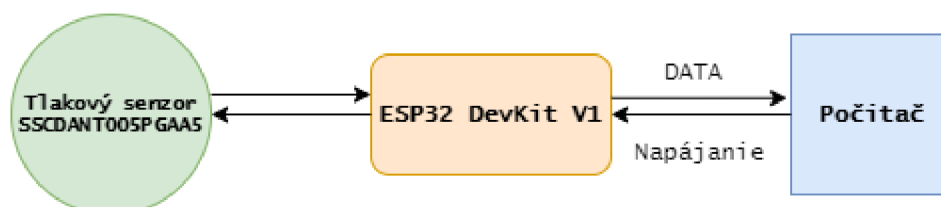
Obrázok 20 Blokové schéma meracieho systému
