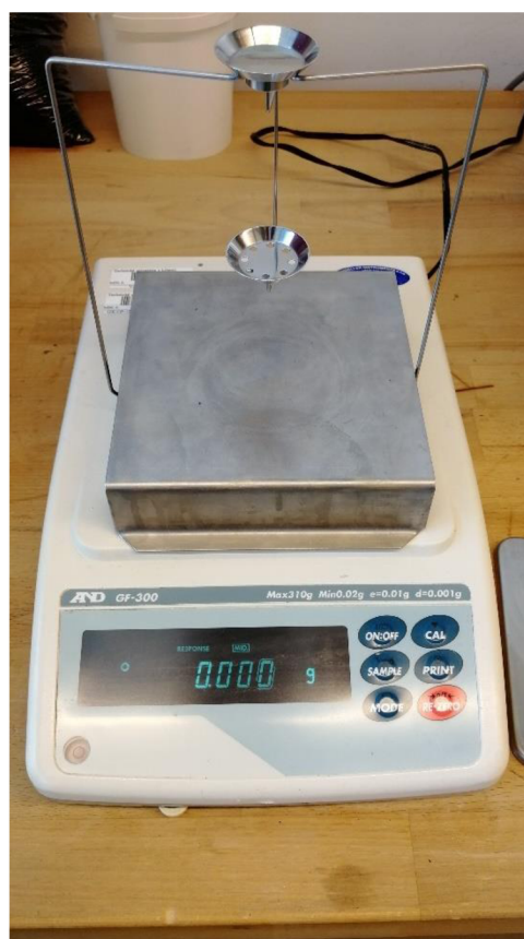
Obr. 29 Váha AND GF-300 (od firmy A&D Weighing)
