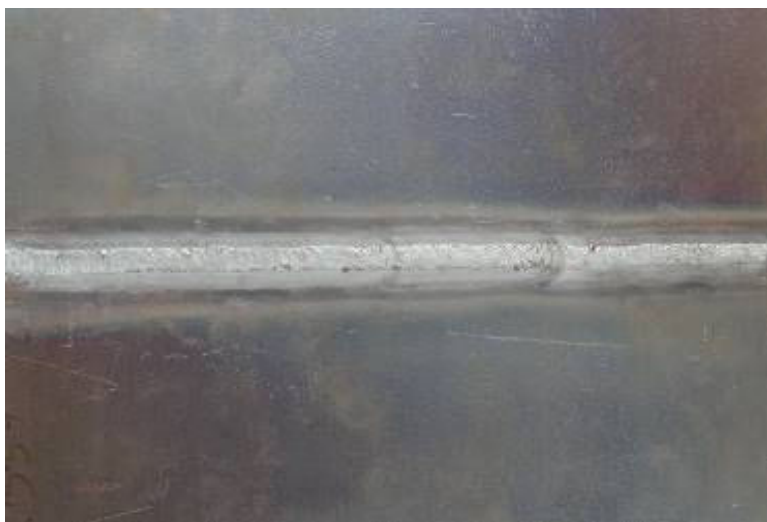
Obr. 56 Kořenová vrstva s přídavným materiálem chromnikl
