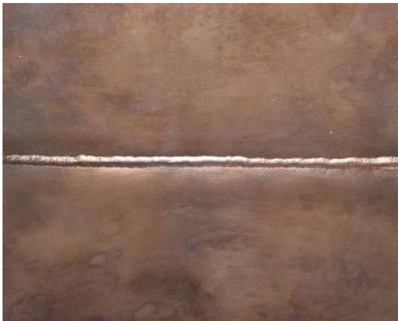
Obr. 47 S přídavným materiálem – kořenová vrstva
