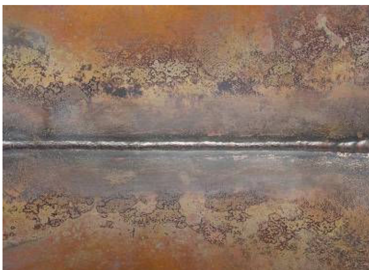
Obr. 43 Bez přídavného materiálu - kořenová vrstva
