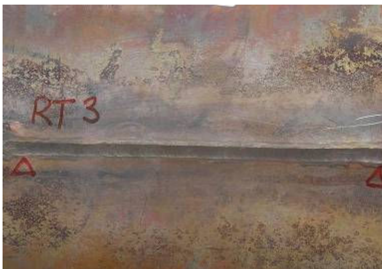
Obr. 42 Bez přídavného materiálu - krycí vrstva a zápaly
