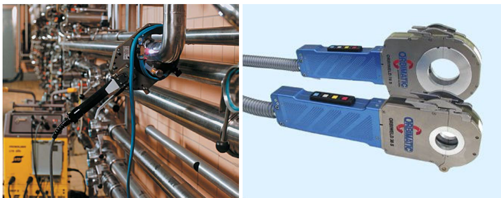
Obr. 7 Svařovací kleště pro orbitální svařování menších průměrů
