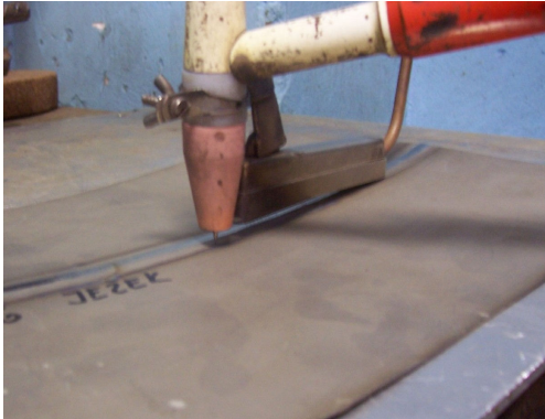
Obr. 3 Přípravek pro ochranu kořenové vrstvy
