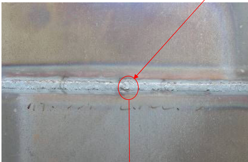
Obr. 53 Kořenová vrstva s přídavným materiálem L-ROL
