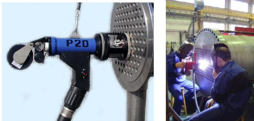
Obr. 8 Svařovací zařízení pro svařování kombinace trubka - trubkovnice
