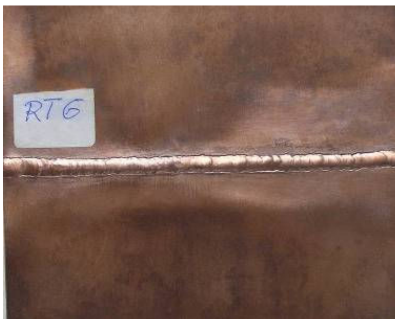
Obr. 46 S přidavným materiálem – krycí vrstva
