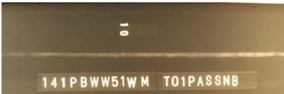
Obr.30 Radiogram – vzorek je vyhovující
