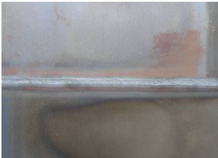
Obr. 50 Kořenová vrstva bez přídavného materiálu
