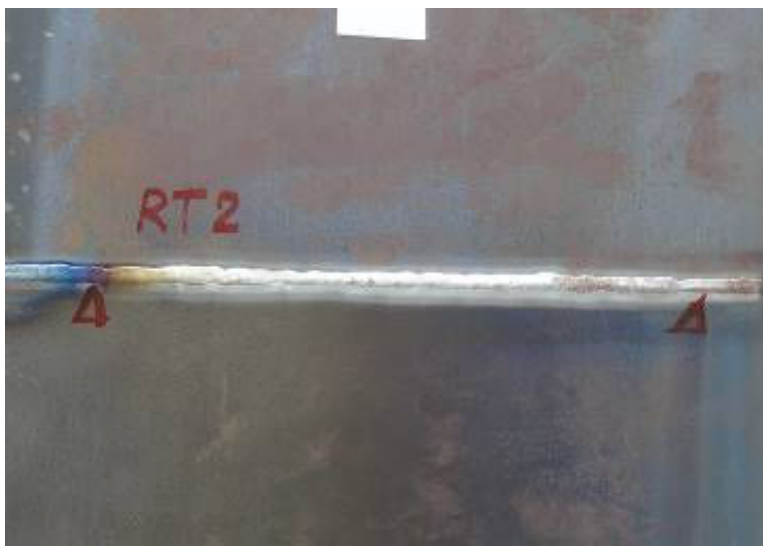
Obr. 51 Radiogram – propadlá krycí vrstva (velký svařovací proud)
