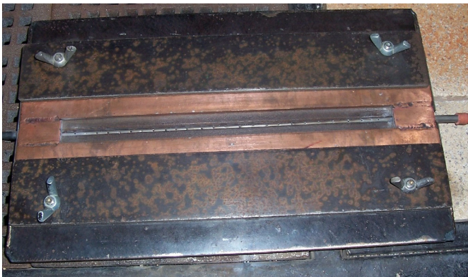
Obr. 3 Přípravek pro ochranu kořenové vrstvy
