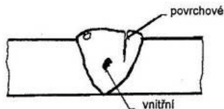
Obr. 18 Rozlišení vad ve svaru podle polohy 3
