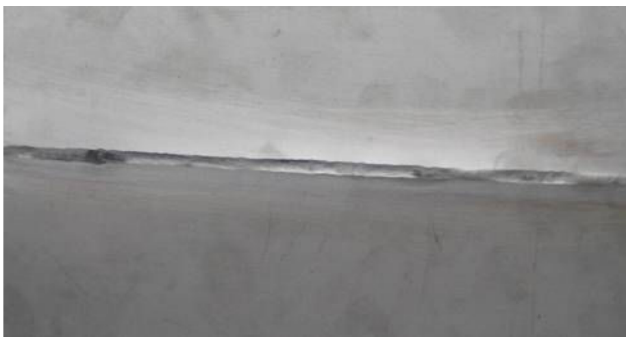
Obr. 41 Nechráněná zčernalá kráterová kořenová vrstva - vzorek nevyhovuje
