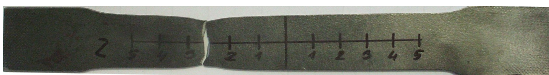
Obr.59 Porovnávací vzorek L-ROL.33 po zkoušce tahem
