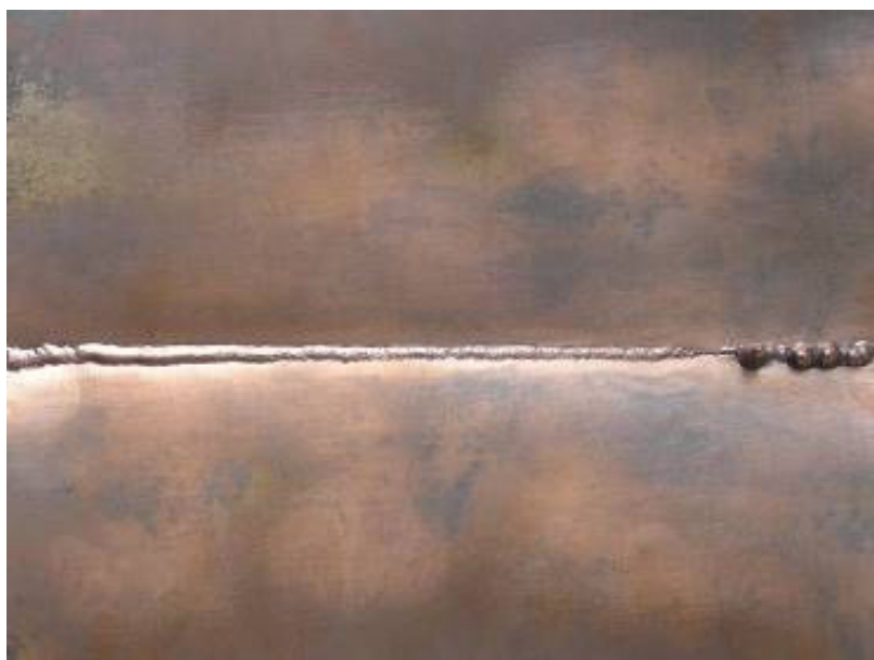
Obr. 46 S přidavným materiálem – krycí vrstva
