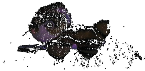
(a) Plyšový tygr s vysokým prahem osvětlení (b) Plyšový tygr s nízkým prahem osvětlení Obrázek 6.11: Skenování pohltivých materiálů
