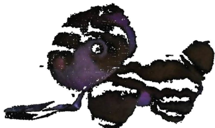
(a) Plyšový tygr s vysokým prahem osvětlení (b) Plyšový tygr s nízkým prahem osvětlení Obrázek 6.11: Skenování pohltivých materiálů
