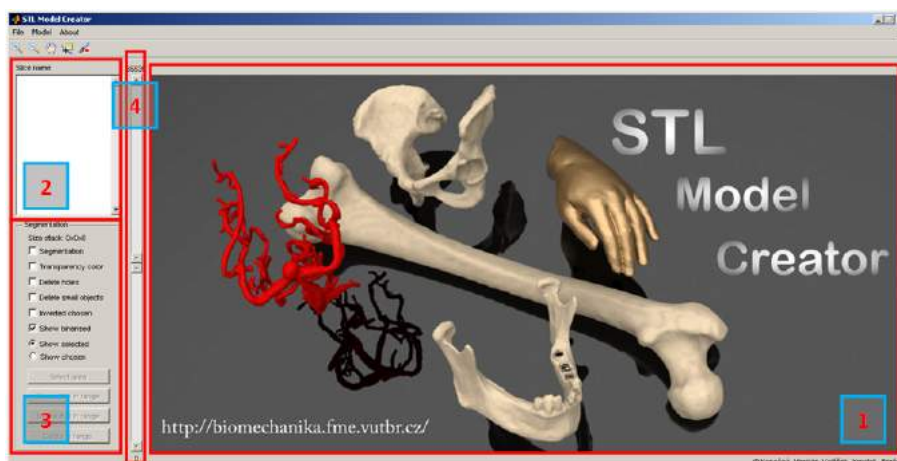
Obrázek 3.1: Pracovní prostředí programu STL Model Creator [54] (1) pracovní plocha, (2) načtená data, (3) panel segmentace, (4) nastavení prahování snímků
