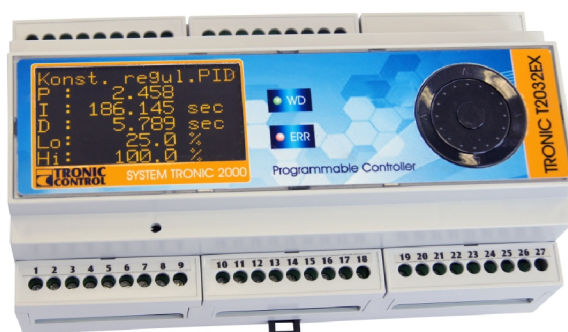
Obr. 3.2: Programovatelná řídicí stanice TRONIC 2032EX
