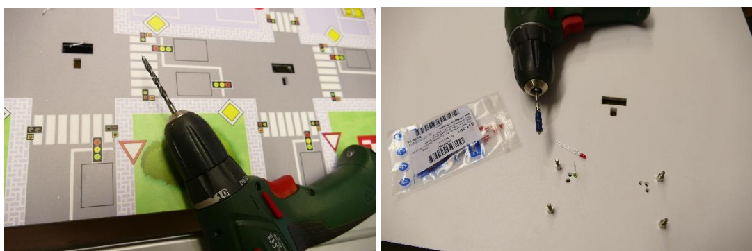
Obr. 7-4 Vyvrtání otvoru pro uchycení plošných spojů
