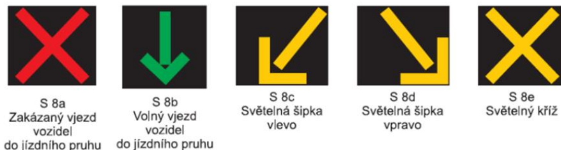
Obr. 4-4 Signalizace pro řízení dopravy v tunelech [6]
