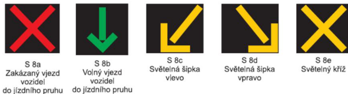
Obr. 4-4 Signalizace pro řízení dopravy v tunelech [6]
