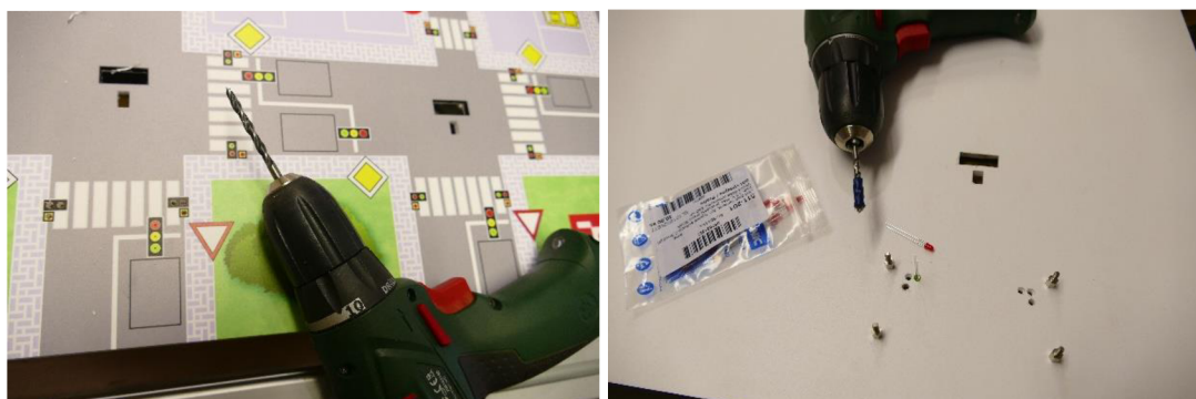
Obr. 7-4 Vyvrtání otvoru pro uchycení plošných spojů
