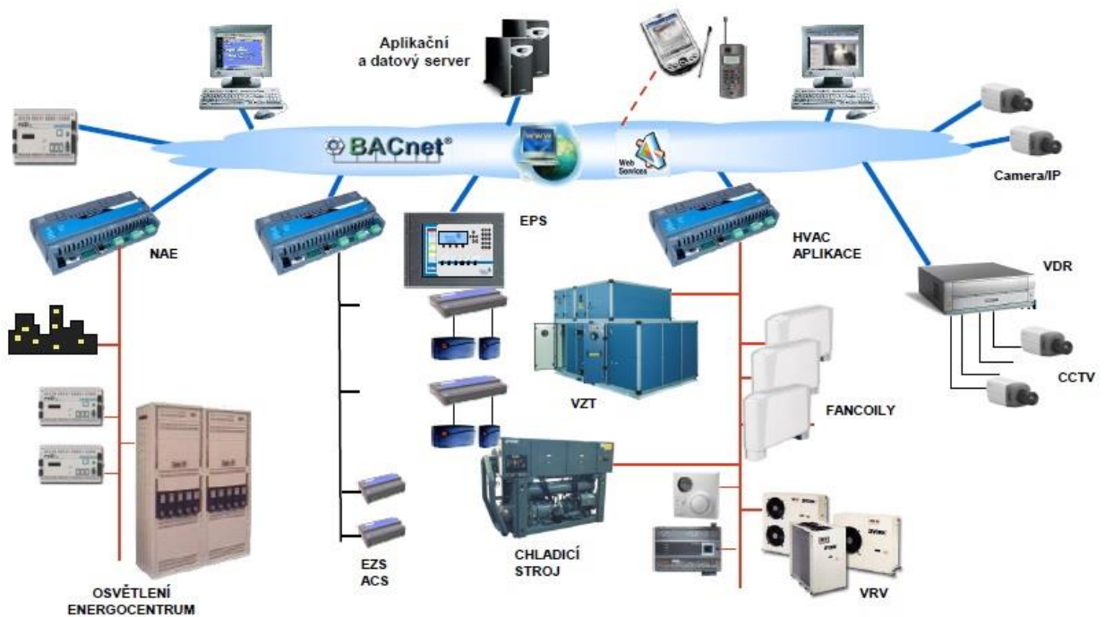
Obr. 2-3 Příklad topologie BMS inteligentní budovy [2]
