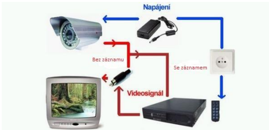
Obr. 2-8 Schéma zapojení uzavřeného televizního okruhu CCTV [9]
