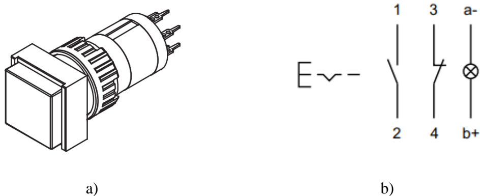
Obrázok 5.4 Tlačidlo EAO 31-483.036: a) Vonkajší tvar tlačidla, b) Vnútorne zapojenie tlačidla
