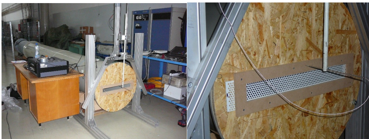
Obr. 8 Ventilátorová dráha ve VZLÚ v Praze, detail osazení mřížky v záklopu [27]
