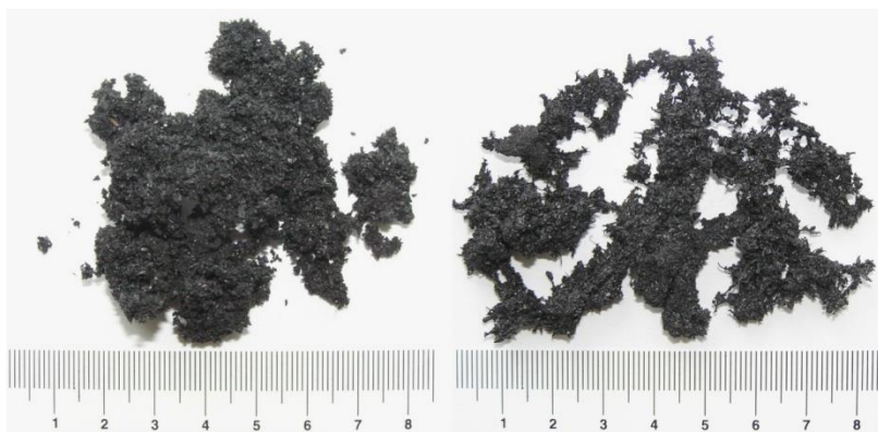
Obr. 3 Srovnání části zbytkového granulátu po extrakci asfaltu rozpouštědlem (vlevo po 2 hodinách a vpravo po 72 hodinách při teplotě 180 °C)
