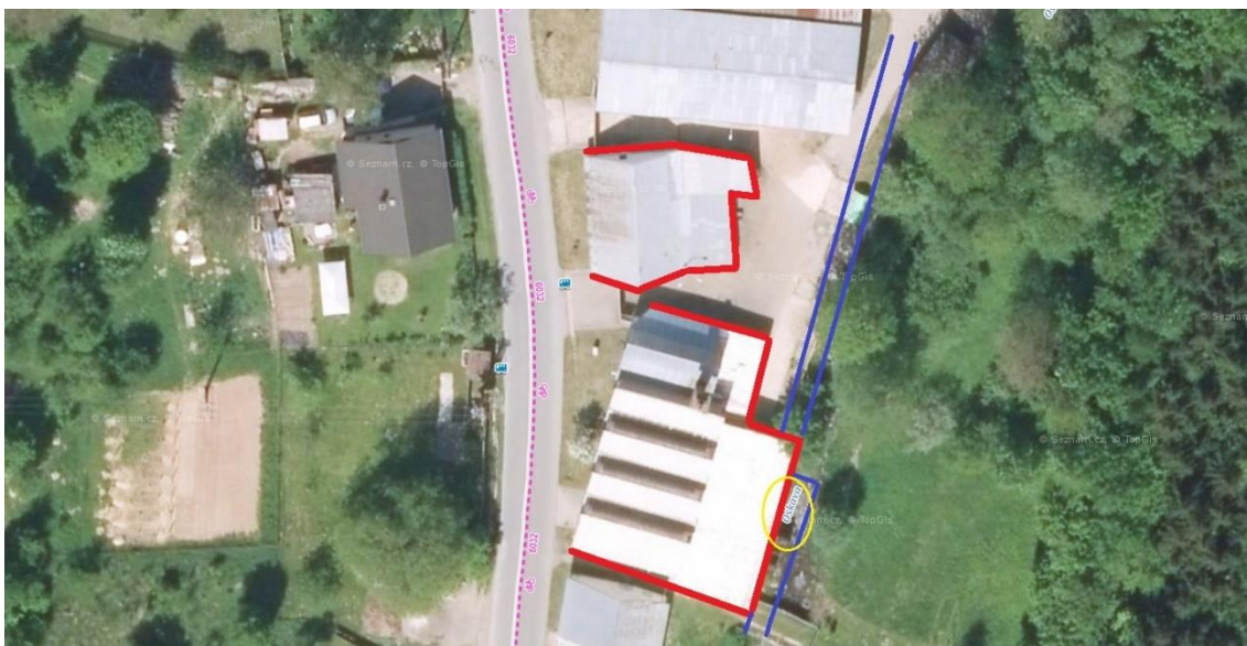
Obr. č. 4: Předpokládaná pozice turbíny v lokalitě objektu č.p. 3 (Červeně: objekty dle plánu a č.p. 3, modře: předpokládaná lokalizace náhonu, žlutě: předpokládaná lokalizace turbíny a její výpusti, zdroj: https://www.mapy.cz , pozn. letecké snímky společnosti Seznam, pořizené v roce 2018 pro Moravu a Slezsko)
