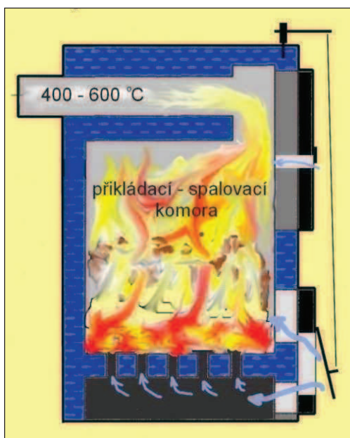
Obr. 16: Schéma prohořivacího kotle [2]
