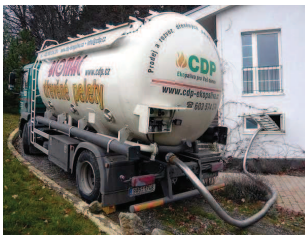
Obr. 13: Cisterna na pelety plnící sklad [17]
