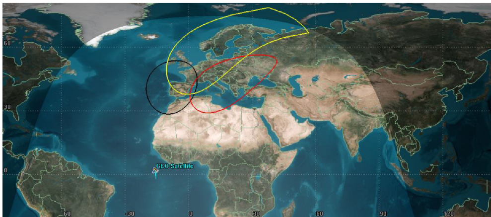
Obr. 1.5: Příklad pokrytí satelitem na GEO [5]
