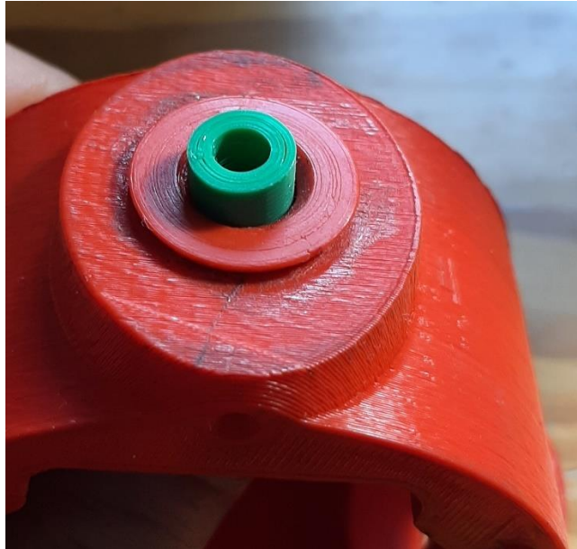
Obrázek 39 Původní uložení čepu PP_3003_01 na valivých ložiskách
