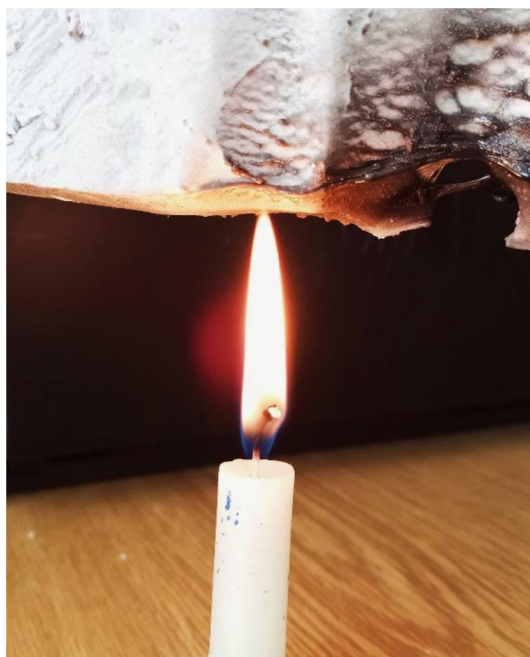
Obrázek 9: Úprava extrudovaného polystyrenu nad plamenem.
