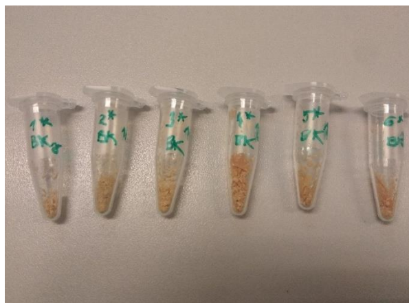
Obrázok č. 13: Eppendorfove skúmavky obsahujúce vysušenú biomasu pripravenú k analýze metódou ATR-FTIR
