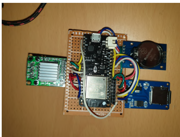
Obrázek C.2: Prototyp sestavený na univerzální desce (bez napájecího obvodu).
