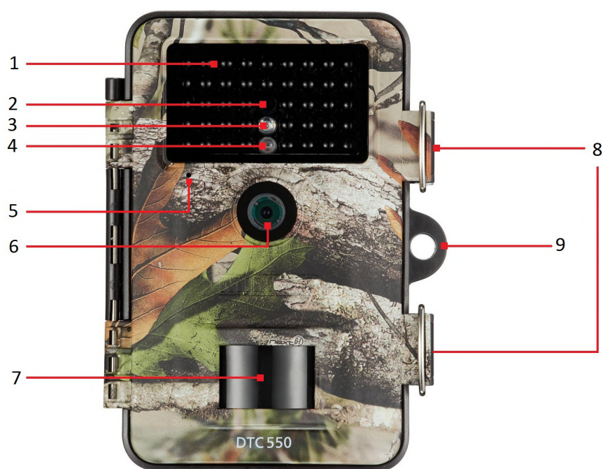
Obrázek 2.1: Složení moderní fotopasti Minox-DTC-550. (1) Infračervené LED přisvětlení. (2) Senzor okolního osvětlení. (3) Modrá signalizační LED. (4) Červená signalizační LED. (5) Mikrofon. (6) Digitální kamera. (7) Detektor pohybu. (8) Upínací svorky. (9) Oko pro uchycení zámku. 1
