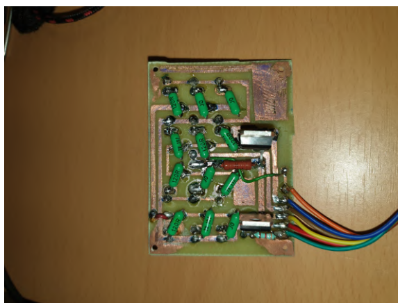
Obrázek C.4: Deska přisvětlovacího systému po vyleptání a osazení.
