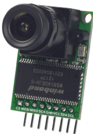
Obrázek 3.6: Kamerový modul OV5642 s FIFO bufferem. 14
