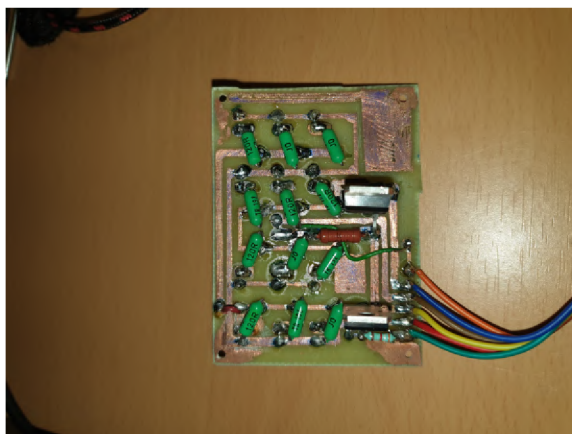
Obrázek C.4: Deska přisvětlovacího systému po vyleptání a osazení.
