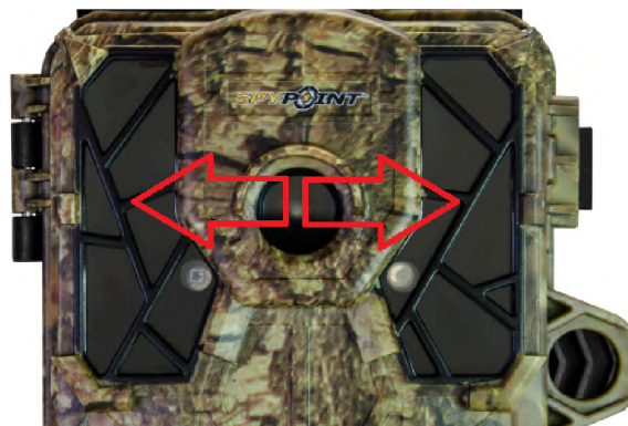
Obrázek 2.10: Minimalizace odleskových ploch přisvětlovacího systému tvarováním krycích polymerových stínidel. 9
