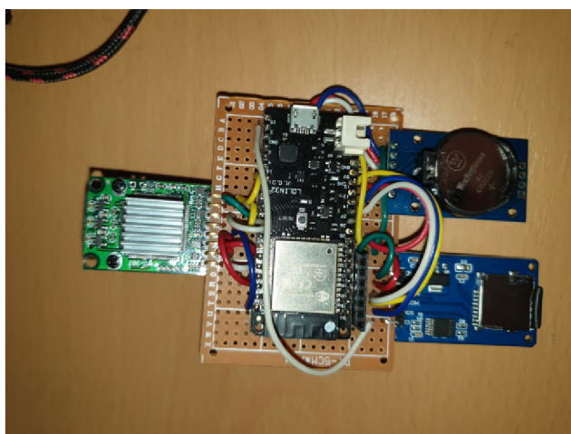
Obrázek C.2: Prototyp sestavený na univerzální desce (bez napájecího obvodu).
