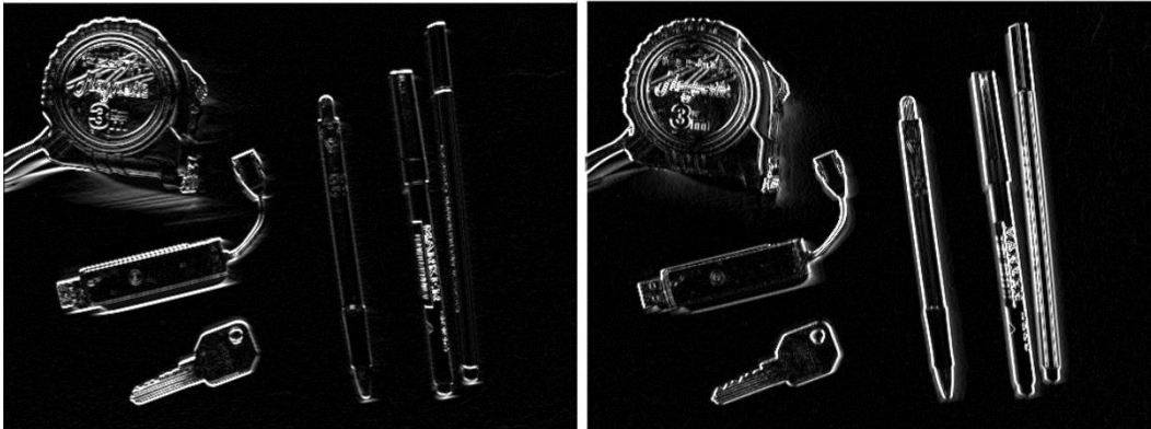
Obrázek 1.9 Gradientní obraz po aplikaci Sobelova hranového detektoru pro vertikální směr (vlevo) a pro horizontální směr (vpravo)
