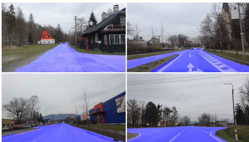
Obrázek 4.5 Ukázka výsledků segmentace vozovky s „occo“ filtrací obrazu
