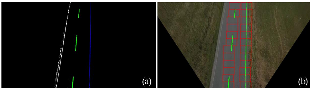
Obrázek 4.10 Ukázka detekce jízdních pruhů pomocí posuvných oken
