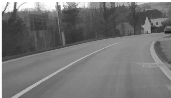
Obrázek 3.4 Ukázka zjednodušeného obrazu pomocí morfologických transformací
