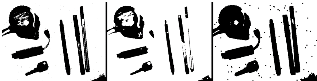
Obrázek 1.13 Ukázka dilatace a eroze - vlevo je originální obrázek, uprostřed dilatace a napravo eroze
