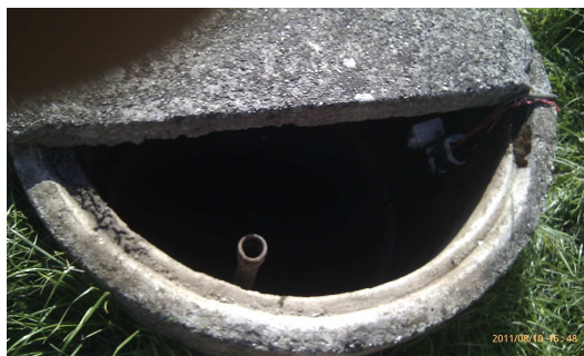
Obr. 32: Umístění dataloggeru MINILOG a senzoru pro měření výšky hladiny ve studni ve Vysokém Poli
