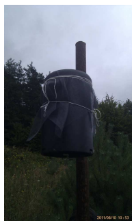
Obr. 41: Srážkoměr Amet s dataloggerem HOBO Ebeny
