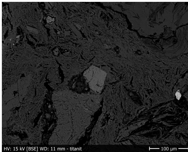
Obr. 24: Keramický fragment 05/2008-1158/93 po přepalu na 1200°C. Zrno titanitu, SEM.
