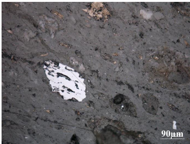
Obr. 15: Vzorek před výpalem. Zrno hematitu v odraženém světle.
