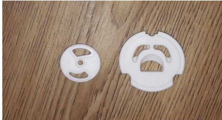
Obrázek 38: Těsnící kroužky do vodovodních baterií z \text{Al}_2\text{O}_3
