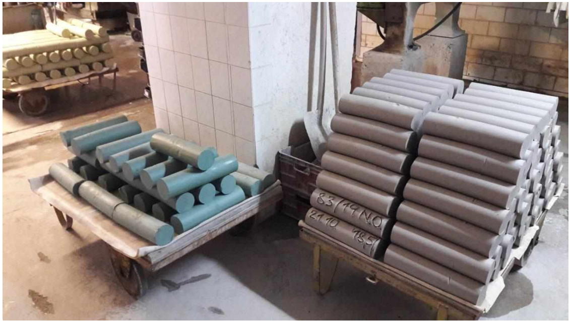
Obrázek 29: Keramické těsto Kordierit
