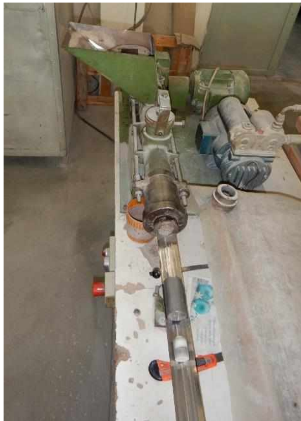
Obrázek 18: Stroj pro tažení keramických výrobků z plastického keramického těsta
