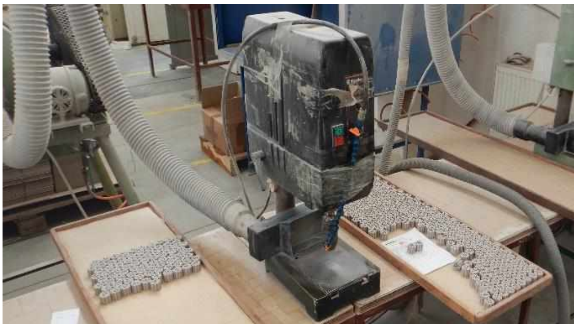
Obrázek 21: Vrtačka na keramické polotovary
