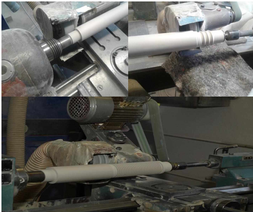
Obrázek 31: Obrábění závitů na kotoučové brusce
