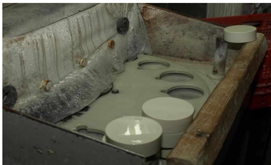
Obrázek 32: Aplikace glazury na podložky pod trafa
