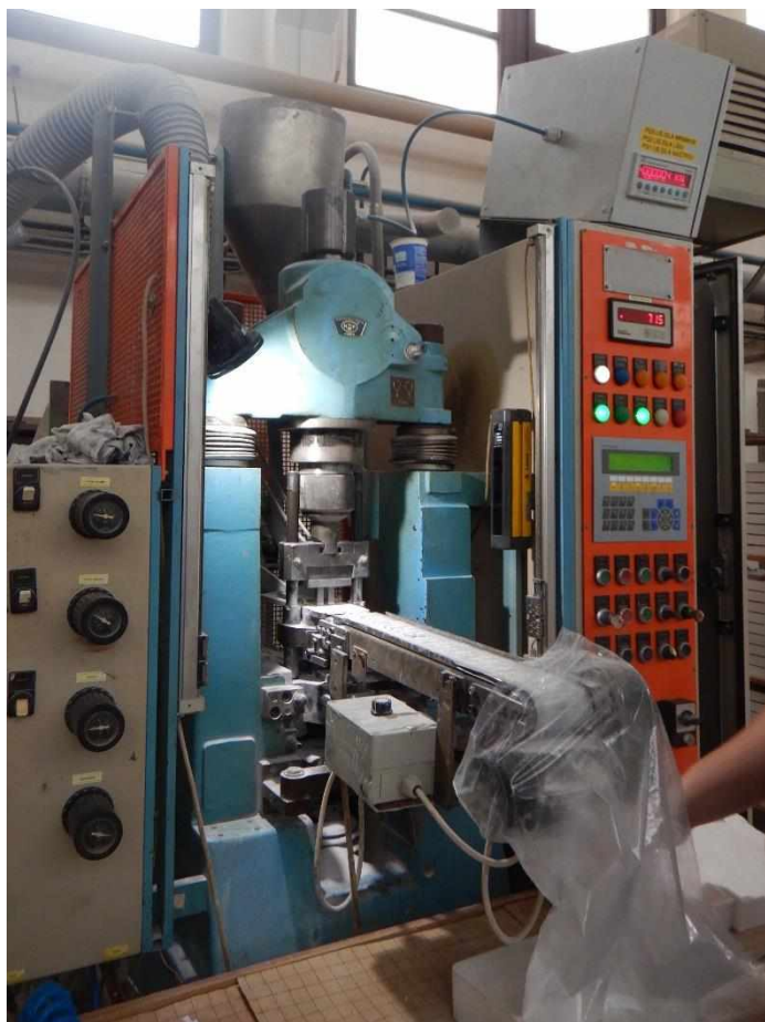
Obrázek 16: Lis DORST TPA pro sériovou výrobu keramických výrobků
