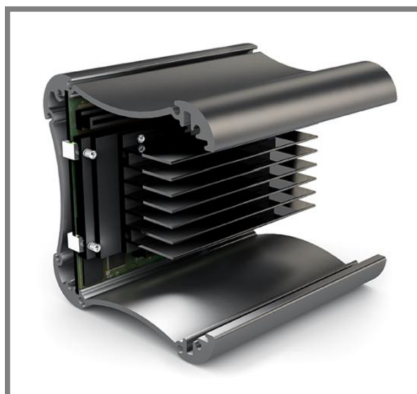
Obr. 7 Xi3 Piston - konstrukce
