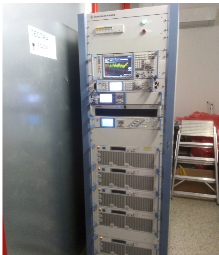
Obr. 4.12 EMC přijímač se zabudovanými vstupními zesilovači
