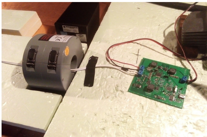
Obr. 4.17 DC-DC měnič s cívkou generující rušení na napájecích vodičích.
