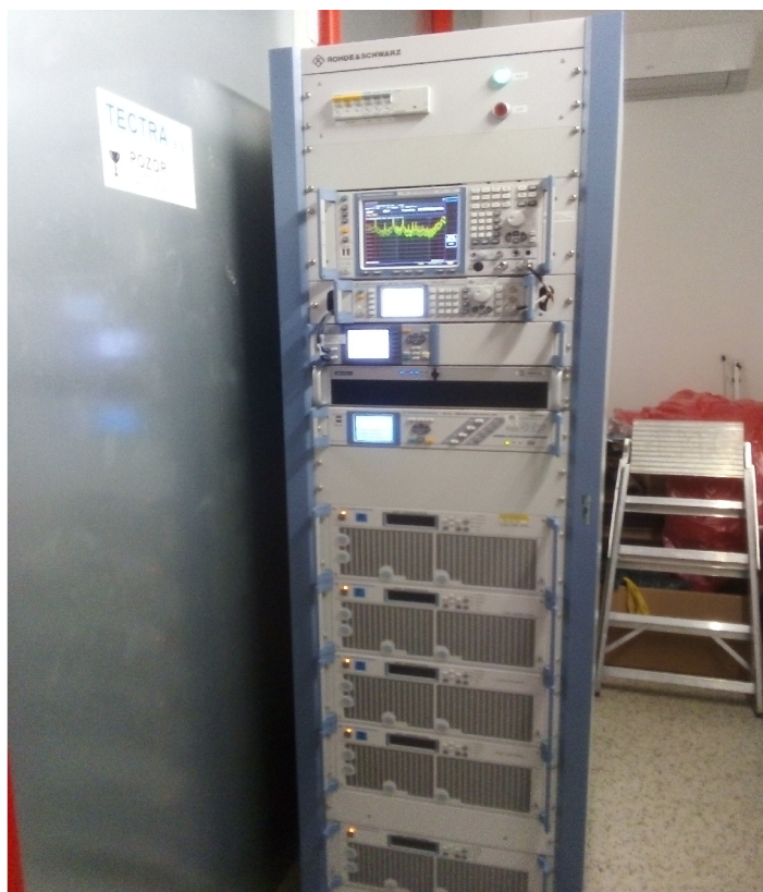
Obr. 4.12 EMC přijímač se zabudovanými vstupními zesilovači
