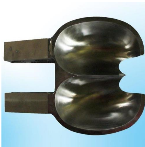
Obrázek 1.8 Koreček Peltonova kola [14]
