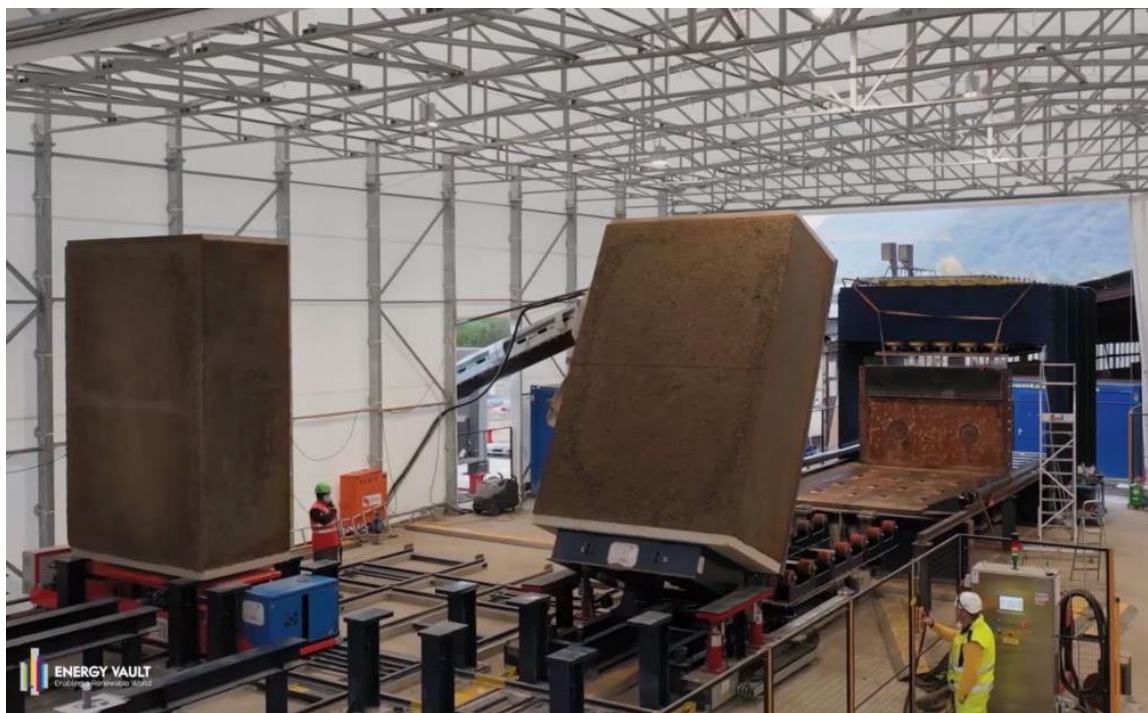
Obr. 33 Výroba kompozitních závaží [88]
