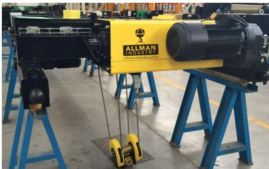
Obr. 45 Elektrický lanový kladkostroj s nosností 20 tun [102]
