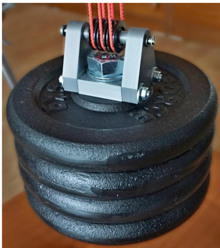
Obr. 34 Závaží a dolní část kladkostroje
