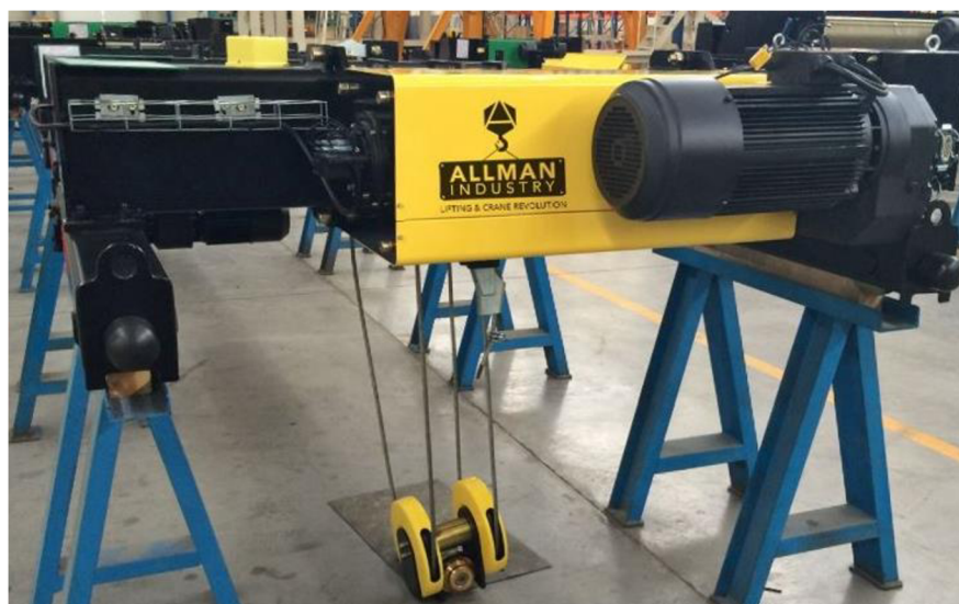
Obr. 45 Elektrický lanový kladkostroj s nosností 20 tun [102]
