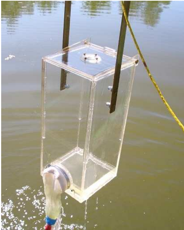
Schindlerův kvantitativní sběrač na zooplankton na objem 10 l.
