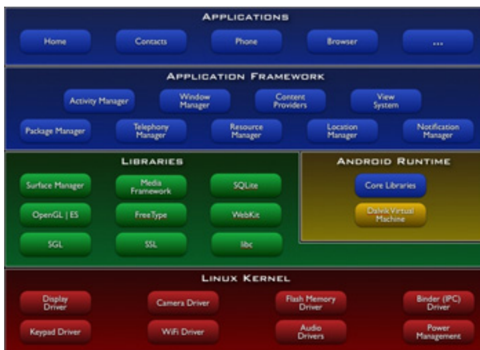
Obrázek 4: Architektura operačního systému Android [4]
