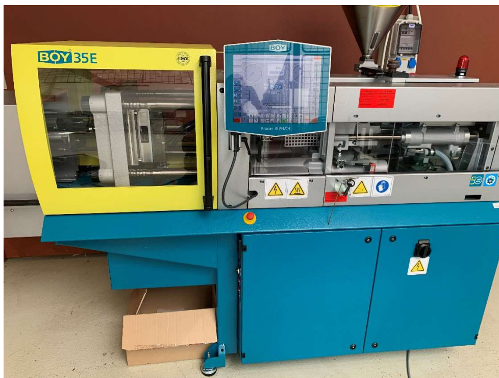
Obr. č. 26: Vstřikovací lis Boy 35 E pro výrobu polymerů vstřikovací technologií
