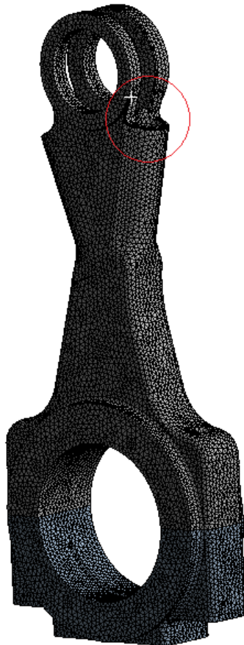
Obr. 36 – Sieť ojnice pre výpočet deformácie a napätia podľa HMH
