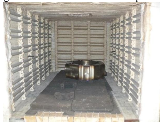
Fotografie č. 9- Naplňování pece vsázkou Fotografie č. 10 - Vnitřní část žíhací pece
