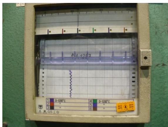
Fotografie č. 7, 8 – Digitální grafické znázornění průběhu žíhání, Záznam na svitkový papír
