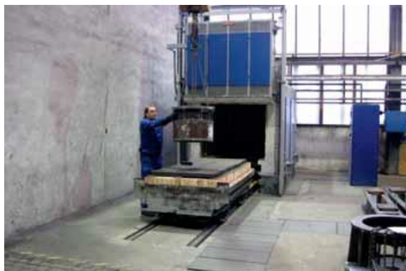
Fotografie č. 9- Naplňování pece vsázkou Fotografie č. 10 - Vnitřní část žíhací pece
