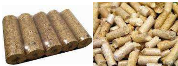
Obr. 3.2 Produkty po zpracování dřevin: Brikety, peletky [12]
