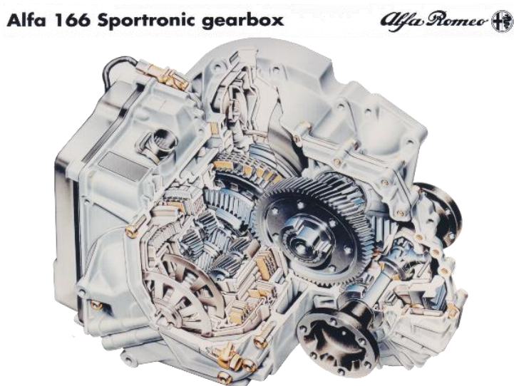
Obrázek 3-14 Převodovka Alfa Romeo Sportronic [60]
