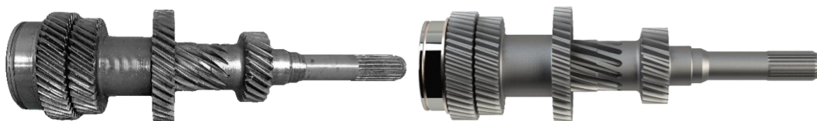
Obrázek 5-24 Sestava hnacího hřídele – porovnání skutečnosti a modelu [zdroj: Autor]
