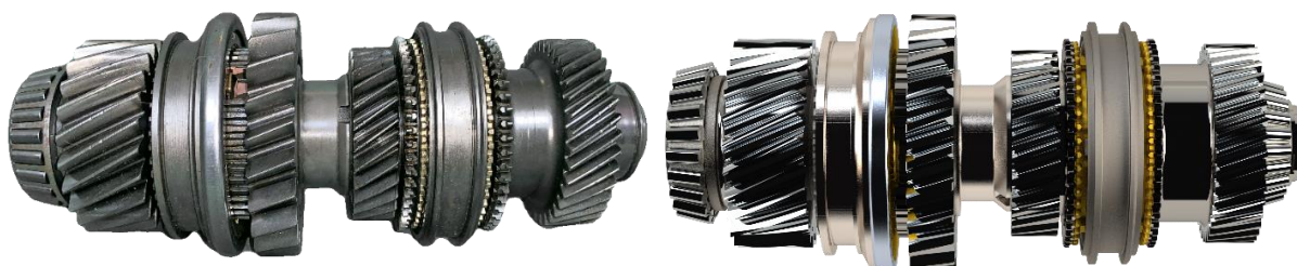
Obrázek 5-28 Hnaný hřídel 5. až 6. stupně – porovnání skutečnosti a modelu [zdroj: Autor]
