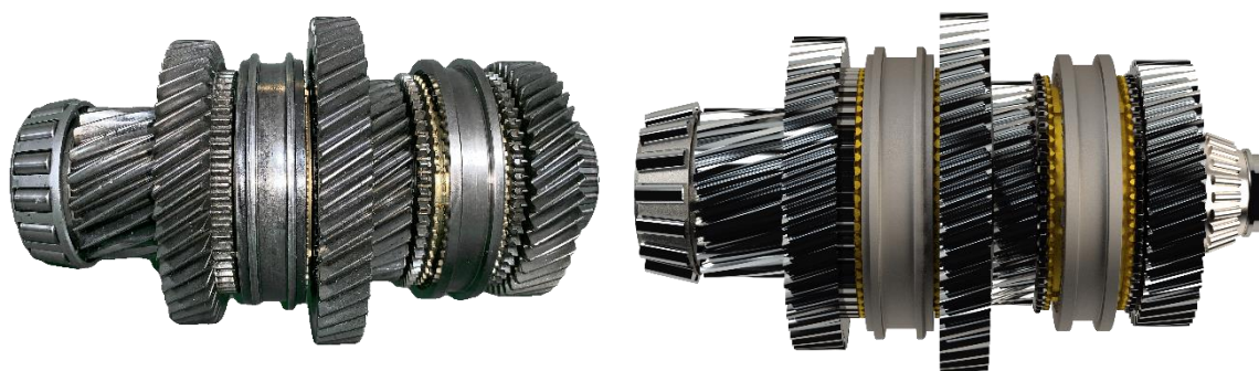
Obrázek 5-26 Sestava hnaného hřídele 1. až 4. stupně – porovnání skutečnosti a modelu [zdroj: Autor]
