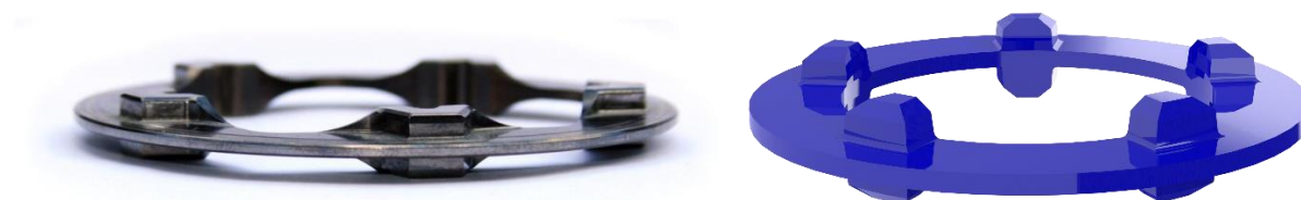
Obrázek 5-49 Přesuvník zubové spojky F1 [108] Obrázek 5-50 Vymodelovaný přesuvník [zdroj: Autor]
