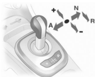
Obrázek 3-7 Řadicí páka automatizované mechanické převodovky vozidla Opel Corsa [45]
