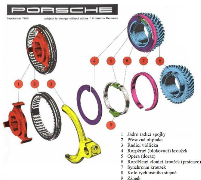
Obrázek 1-9 Synchronizace systému Porsche [16]
