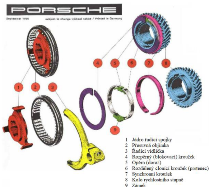
Obrázek 1-9 Synchronizace systému Porsche [16]
