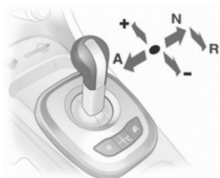
Obrázek 3-7 Řadící páka automatizované mechanické převodovky vozidla Opel Corsa [45]
