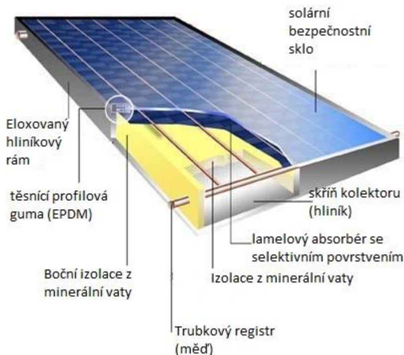
Obrázek 7: Hlavní součásti plochého slunečního kolektoru. (CNE 2016)
