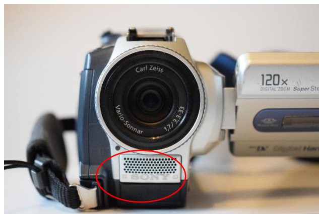
Obr.24 Mikrofon videokamery Sony Handycam DCR-TRV18 mikrofon je umístěn pod objektivem
