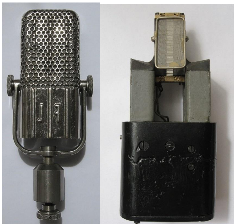
Obr.36 Elektrodynamický páskový mikrofon FRANTIŠEK LIPPERT [64] páskový mikrofon využívaný v Československém rozhlase ve třicátých letech 20. století
