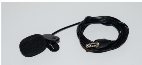
Obr.40 Kondenzátorový všesměrový klopový mikrofon
