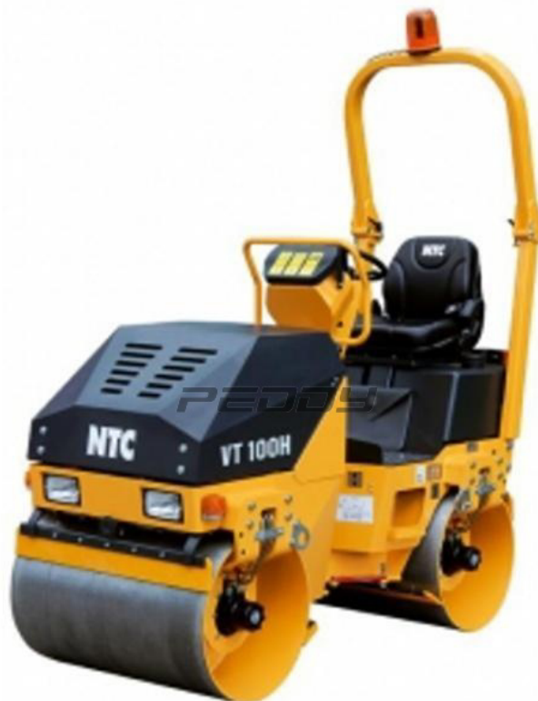
Obr. 5.21: Tandemový vibrační válec NTC VT 100
