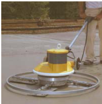
Obr. 5.22: Víceúčelový rotační stroj SCHWAMBORN STR 702 S
