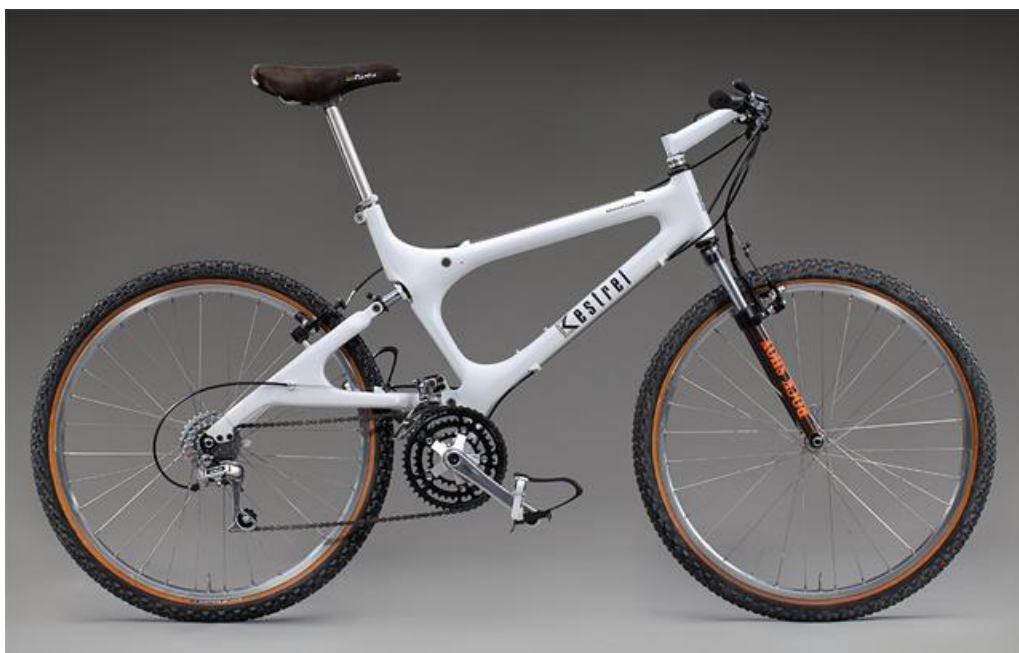
Obrázek 6. První odpružení Rock Shox na kole Kestrel Nitro z roku 1991 (Zdroj: mtbs.cz )
