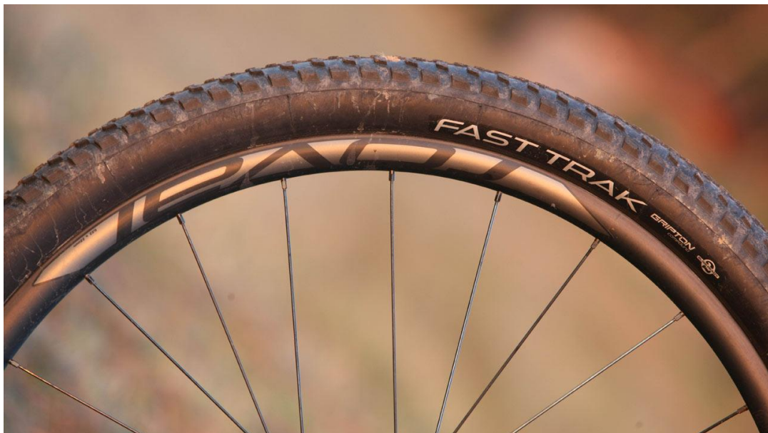
Obrázek 12. Zapletená kola Roval s karbonovými ráfky obuté do plášťů Specialized Fast Trak Gripton na testovaných kolech (Zdroj: mtbs.cz)
