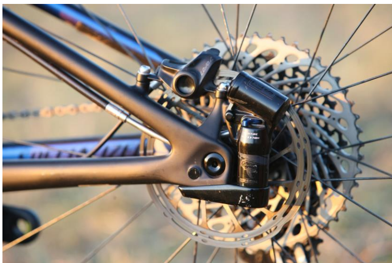
Obrázek 15. Jednotka Brain na testovaném kole Specialized Epic Pro (Zdroj: mtbs.cz)
