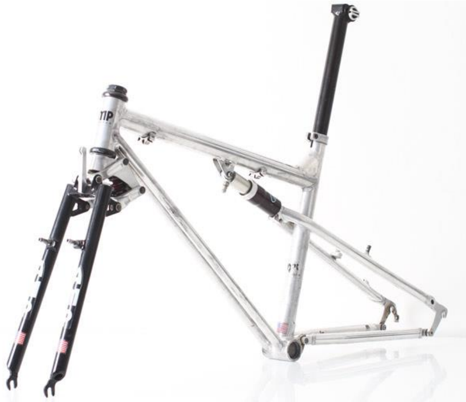
Obrázek 7. Čtyřčepové zadní odpružení Horsta Leitnera na rámu AMP z roku 1992 (Zdroj: mtbs.cz)
