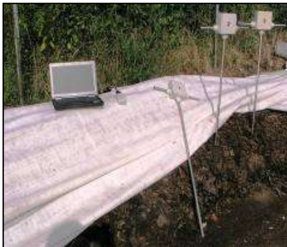
Obr. č. 4: Zapichovací snímače teploty a sběrná řídicí jednotka s přijímačem signálu (Plíva a kol., 2010)
