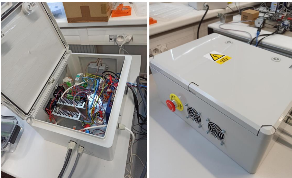
Obrázek 6-23 Elektrická skříň obsahující průmyslové zdroje, jističe, drivery a vývojovou desku Arduino.
