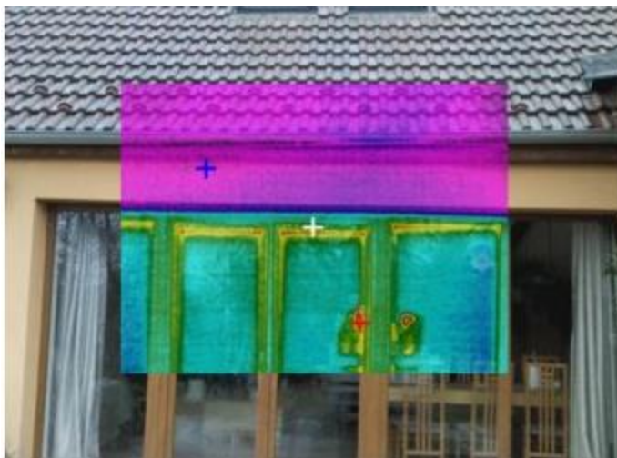
Obrázek 3.4: Funkce obraz v obraze s částečnou průhledností.
