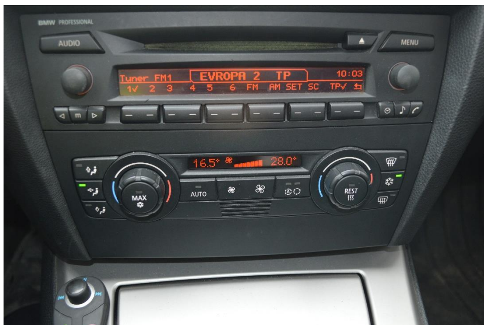
Obrázek 3.11: Ovládání topení u vozu BMW E90.
