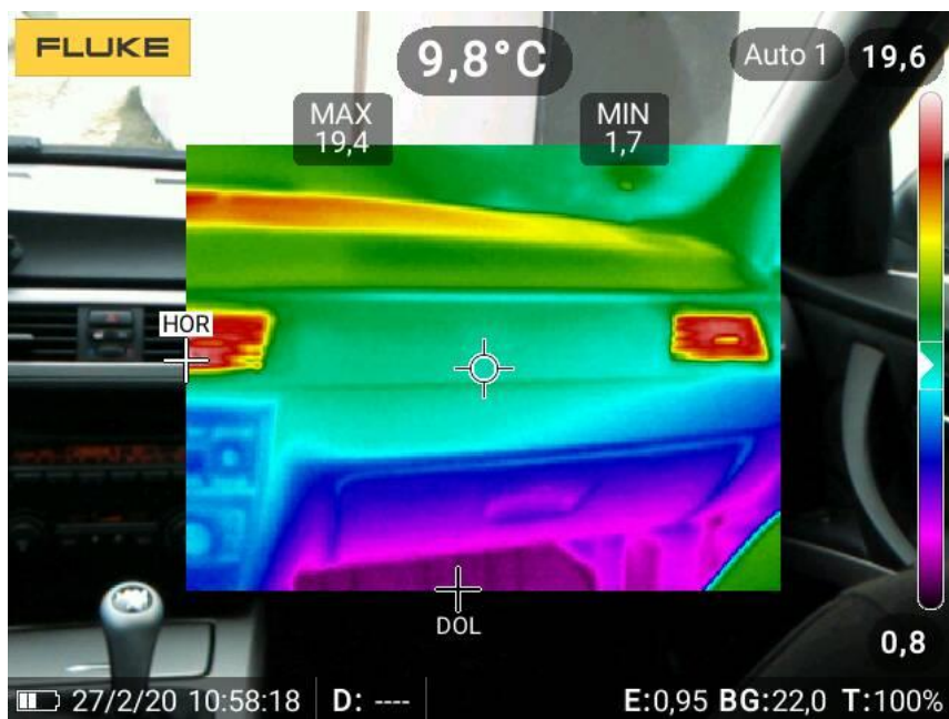
Obrázek 4.8: Termogram výdechů topení u spolujezdce.
