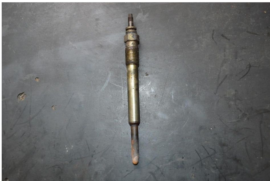
Obrázek 3.9: Žhavicí svíčka u vozu Peugeot 206.
