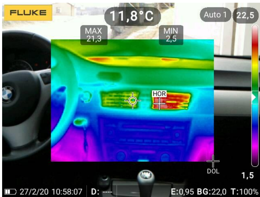
Obrázek 4.7: Termogram výdechů topení uprostřed vozidla.
