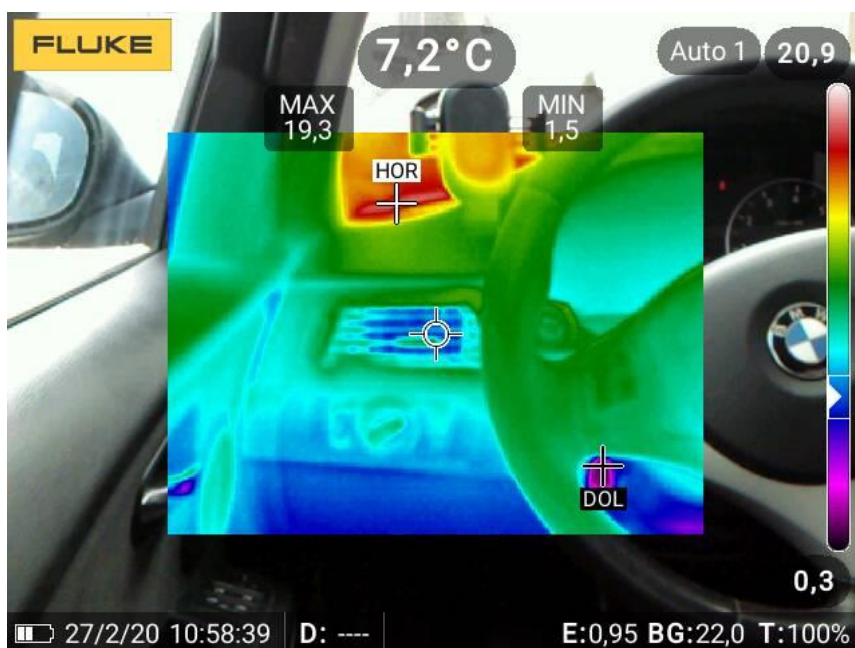
Obrázek 4.8: Termogram výdechů topení u spolujezdce.
