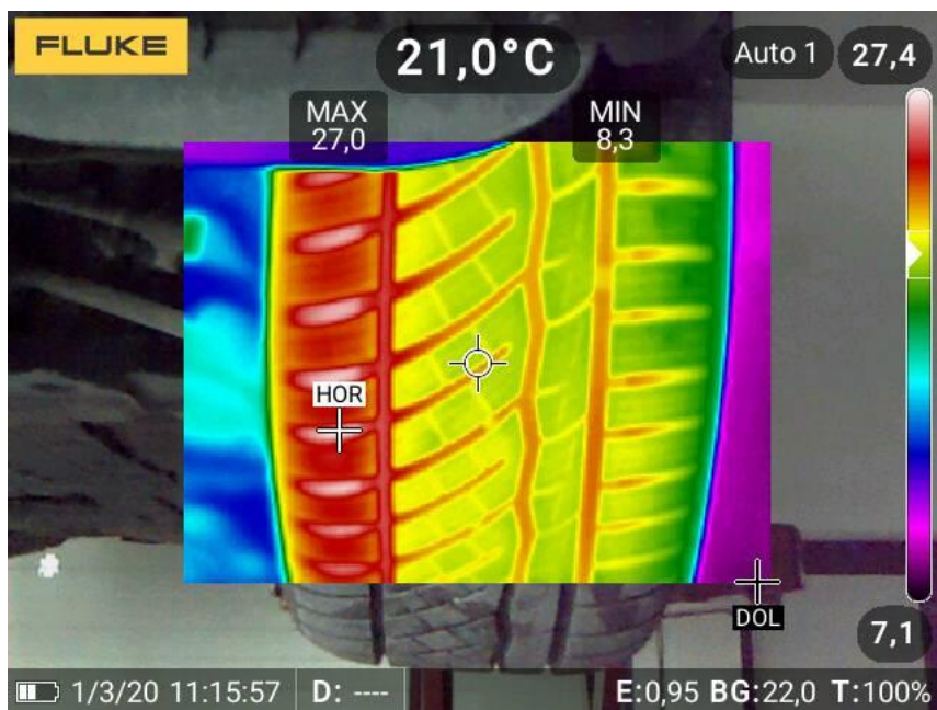
Obrázek 4.10: Termogram opotřebení pneumatiky přední nápravy na straně řidiče.
