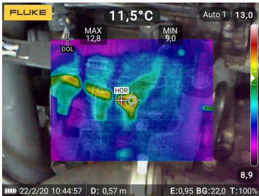
Obrázek 4.1: Ohřátí kontaktu a kabelu žhavicích svíček po několika sekundách.
