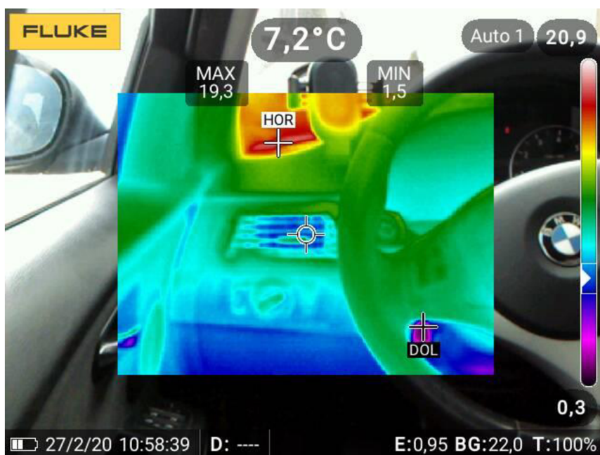
Obrázek 4.8: Termogram výdechů topení u spolujezdce.
