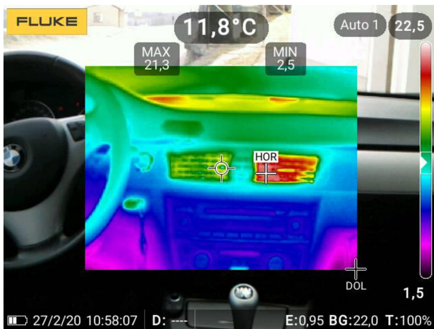
Obrázek 4.7: Termogram výdechů topení uprostřed vozidla.
