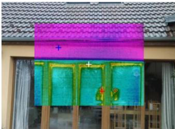
Obrázek 3.4: Funkce obraz v obraze s částečnou průhledností.
